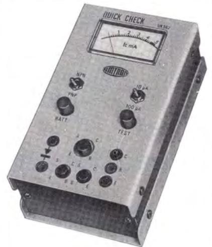
Un apparecchio pratico, di facile uso, leggero e facilmente portatile. Misura il beta dei transistori NPN e PNP, e fornisce una chiara indicazione della funzionalità di transistori e diodi pur senza necessitare di complicate procedure di misura o di calcoli. Indispensabile nella borsa e nel laboratorio.
