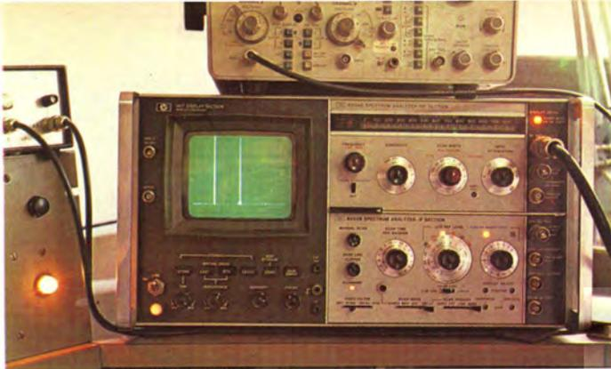
Fig. 15 - AN/SPHP 141. In display un eccezionale campo dinamico esente da rumore e intermodulazione di 70 dB. Eccezionale anche il contenuto armonico degli oscillatori. (Riferimenti vedi testo).
