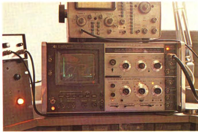
Fig. 18 - AN/SP HP 141T. In display è l'analisi in campo per divisione di  $100$  MHz/cm delle emissioni generali di oscillatori e complesso armonico di portante. (vedi testo).
