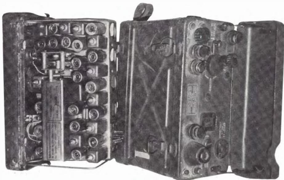
Fig. 1 - Radiotelefono SCR 537 chiuso (a destra) ed aperto.
