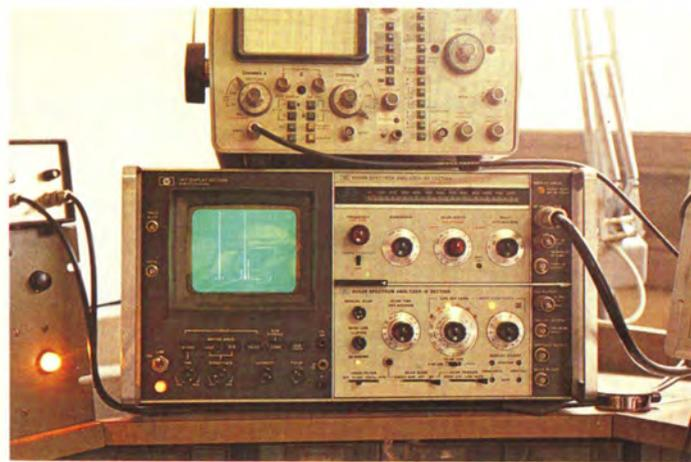
Fig. 17 - AN/SP HP 141T. In display è l'analisi in campo per divisione di  $10$  MHz x cm. Le emissioni degli oscillatori del sintetizzatore TX.
