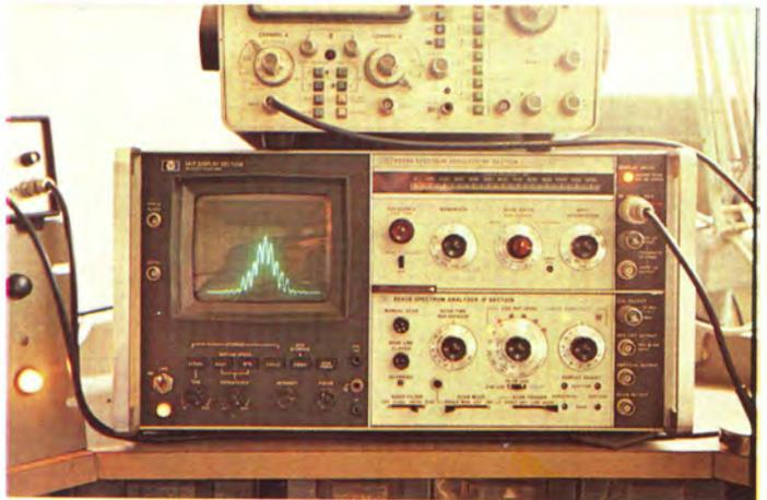
Fig. 5 - AN/SP HP 141T. In display -30 dBm AM/AL 100% di modulazione con tono di 1000 Hz. F = 27.135 kHz.
